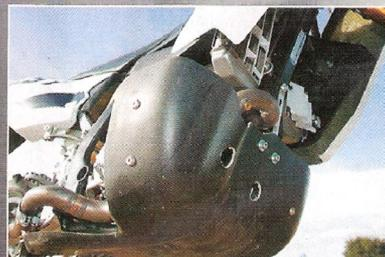
▲ Un gros sabot de protection en carbone, mais une tubulure d'échappement exposée...
