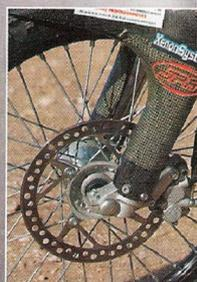
▲ Le disque de 270 mm manque d'un peu de puissance.
